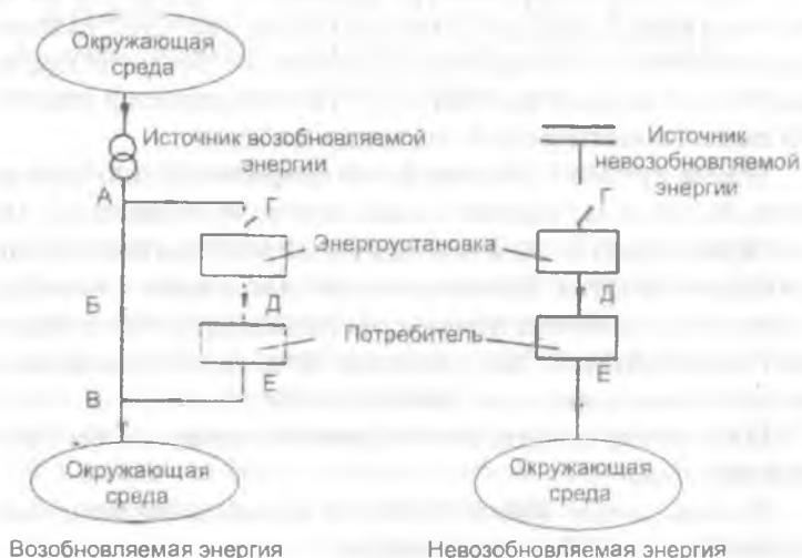
Рисунок 1.1. Схемы процессов использования возобновляемой и невозобновляемой энергии: А, Б, В – неиспользуемый поток возобновляемой энергии; Г, Д, Е – используемый поток энергии
