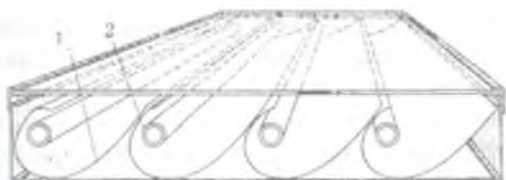
Рисунок 7.3. Солнечный коллектор с отражателем, изогнутым по спирали:
