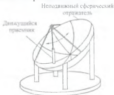
Рисунок 7.5. Солнечный коллектор с неподвижным отражателем и следящим приемником
